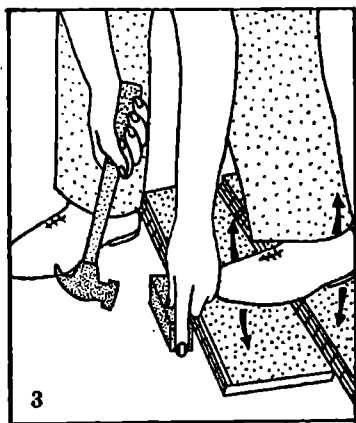
Рис. 38. Технологическая схема установки паркетных досок «Ламелла»:
