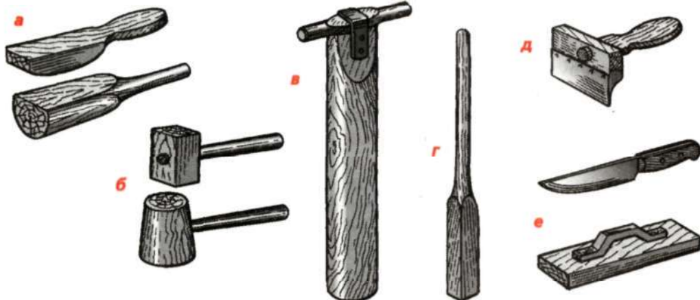
Инструменты для формовки и отделки глинобитной печи: чекмари, колотушки, нож, терка, скребок, трамбовка и пест.
